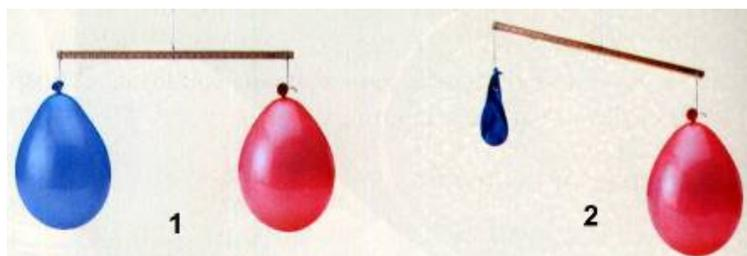
Se inflan los dos globos y se colocan de tal manera que la barra quede en equilibrio. Posteriormente se pincha el globo azul y se ve el movimiento del globo rojo. La hipótesis planteada fue:
